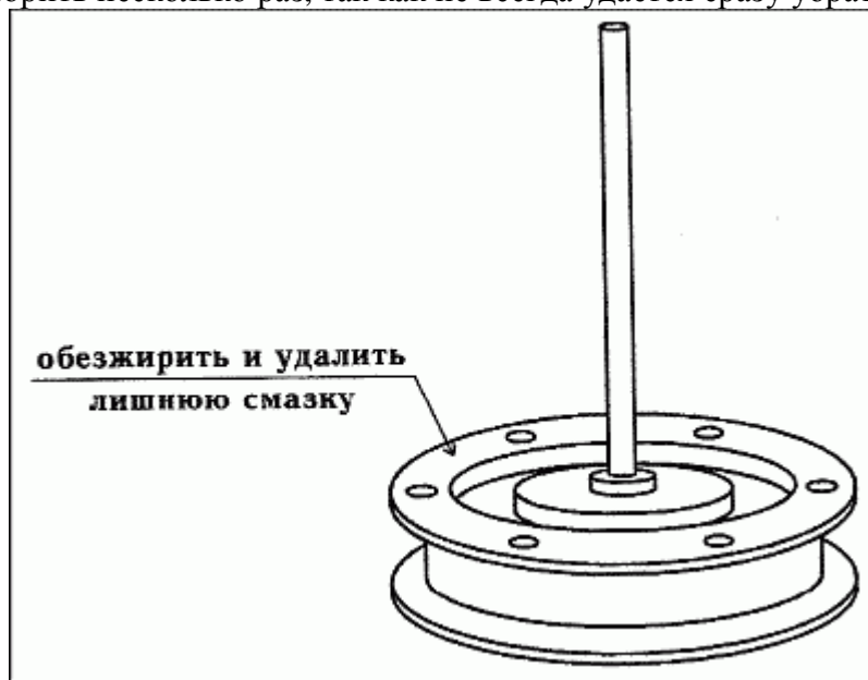
Рис. 85. Удаление лишней смазки с поверхности зеркала катушки
