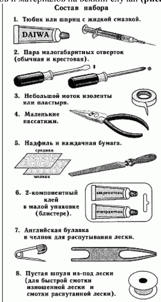
Рис. 2. Набор инструментов и принадлежностей для оказания первой помощи катушке
